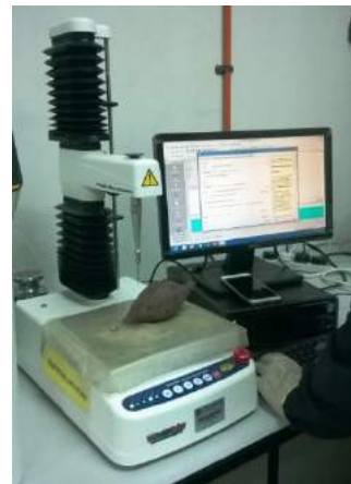
Gambar 5: alat pengukur tekstur model TA.XTplusC dari Stable Micro System
