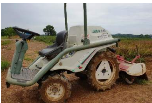
Rajah 2: Traktor mini empat roda (jenis menunggang)
