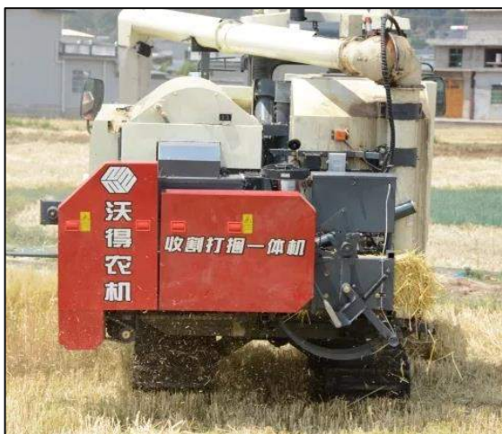
Gambar 1: Mesin jentuai Worldstar 7.0 Plus yang dilengkapi mesin pengumpul jerami.
