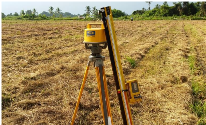
Rajah 1 : Peralatan pengelasan laser (Pemancar isyarat laser, tripod, penerima isyarat laser dan staf pengukur pengelasan)
