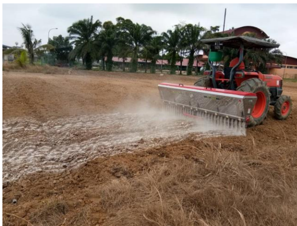
Rajah 3: Pengujian mesin kapur jenis jatuhan di ladang
