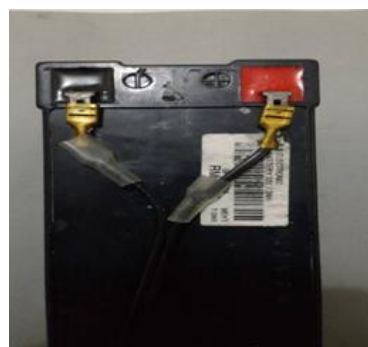
Rajah 8: Proses penyambungan pin ke bateri
