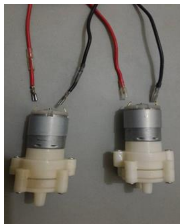
Rajah 6: Pemasangan wayar ke motor
