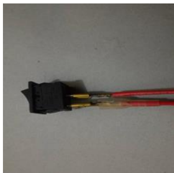
Rajah 7: Proses pemasangan pin ke suis
