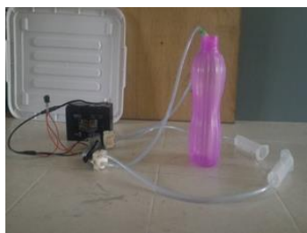
Rajah 12: Pemasangan hos pada motor
