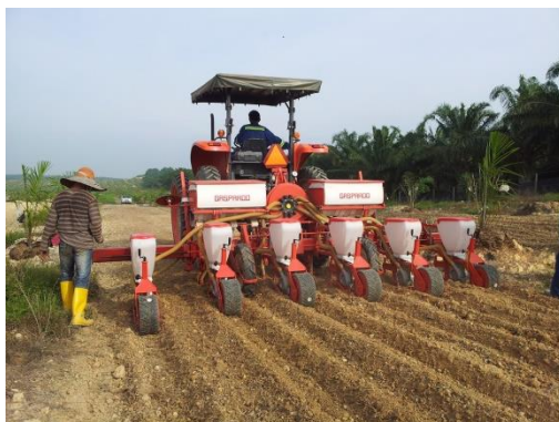
Gambarajah 3: Aktiviti menanam jagung 6-baris secara mekanisasi di ladang kelapa sawit muda
