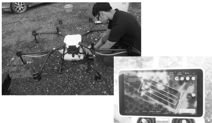
Gambar 2: Dron dan alat kawalan yang digunakan bagi tujuan semburan (DJI-AGRAS MG-1S)
